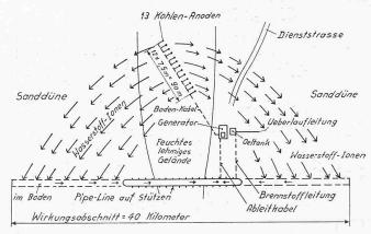
Bild 7. Installationsschema einer «Cathodic Protection»-Anlage. Die 13 Anoden sind auf eine Länge von etwa 100 m in Abständen von je 7,5 m eingegraben
