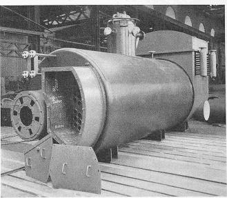
Bild 9. Werkstattaufnahme eines Retourröhrenkessels mit Dampfüber-
