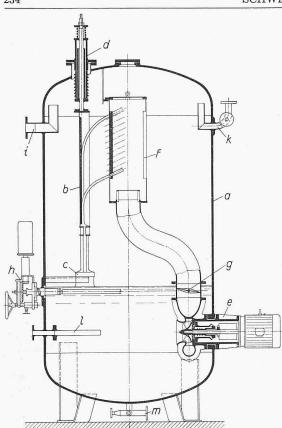
Bild 12 (links). Schnittzeichnung eines Escher Wyss Kaskaden-Elektrokessels
