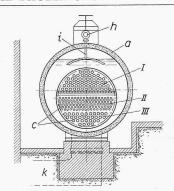
Bild 5. Schnittbild eines Flammrohr-Rauchrohr-Kessels, Typ «H»
