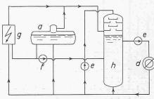
C. Dampf-Heisswasseranlage mit Kaskaden-Umformer und Heisswasser-Speicher
