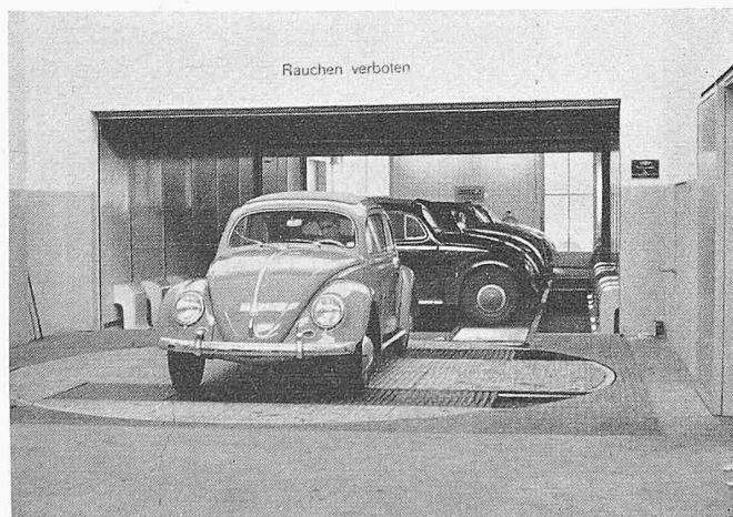
Bild 11. Durchsicht durch die Trockenkabinen der Malerei; im Hintergrund der staubfreie Farbspritzraum. Von diesem laufen die Wagen quer auf einem Transportband durch zwei Trockenkabinen mit 40 und 80° C. Am Ende des Transportbandes, ausserhalb der Trockenkabinen, gelangen sie über eine Drehscheibe zur Fertigstellung
