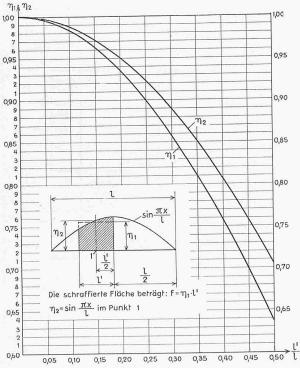
Bild 1. Korrekturfaktoren  $\eta_1$  und  $\eta_2$
