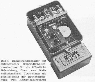
die Schaltfunktionen. Die lichtempfindliche Photozelle ist in der Mitte der Röhren sichtbar. Unter rechts: Der Synchronmotor (rundliches Gehäuse) hat die Aufgabe, jeweils am Morgen die Startervorspannung der Schaltröhren zu erhöhen, so dass der Dämmerungsschalter am Morgen bei geringerer Helligkeit schaltet
