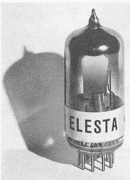
Bild 1. Kaltkathodenröhre mit deutlich sichtbarer kalter Kathode
