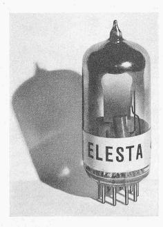
Bild 1. Kaltkathodenröhre mit deutlich sichtbarer kalter Kathode
