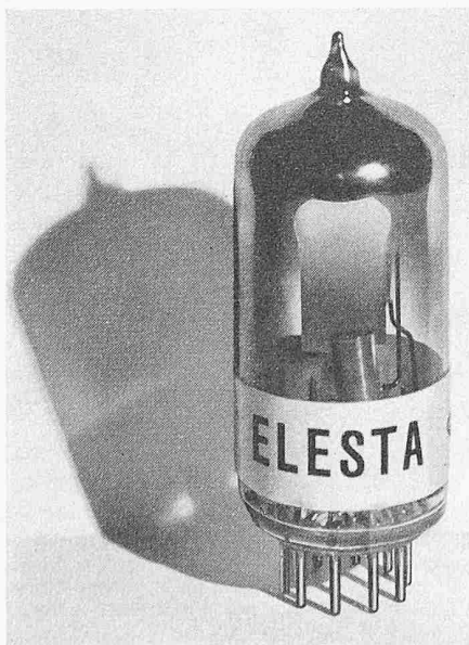
Bild 1. Kaltkathodenröhre mit deutlich sichtbarer kalter Kathode
