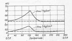
Bild 18b. Druckverlauf im Raum der Kolbenunterseite (ausgezogen) bei zwei verschiedenen Luftdrücken im Spülluftreceiver (gestrichelt) entsprechend zwei verschiedenen Belastungen des Motors (mittl. eff. Kolbendruck 7 bzw. 3 kg/cm²)
