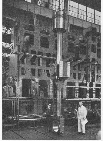
Bild 25. Triebwerk eines Zylinders des Motors 9 RSAD 76
