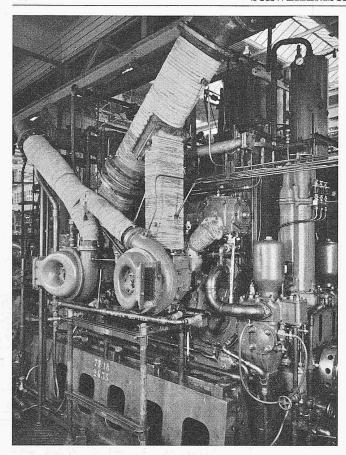
$\operatorname{Bild} 12.$  Der Motor 4 T24mit zwei Turbo-Aufladegruppen und rotierenden Auspuffschiebern auf dem Versuchstand
