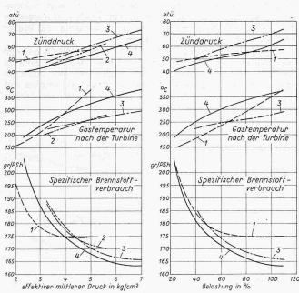
Bild 13. Versuchsergebnisse am Motor 4 T 24 in Funktion des mittl, effektiven Kolbendruckes; 1 ohne Aufladung mittl, eff. Kolbendruck bei Vollast  $p_{me} = 4,66$
