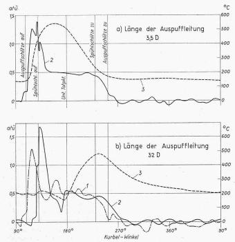
Bild 8. Gemessener Verlauf von Druck und Temperatur der Auspuffgase vor Turbine bei verschieden langen Auspuffleitungen am Einzylinder-Zweitakt-Dieselmotor 1 QA 42 mit Aufladung nach dem Stossverfahren. Drehzahl 300 U/min, mittlerer effektiver Kolbendruck  $p_{me} = 5,65 \, \mathrm{kg/cm^2}.$  D Rohrdurchmesser der Auspuffleitung. 1 Druck nach Auspuffschlitzen, 2 Druck vor Turbine, 3 Temperatur vor Turbine
