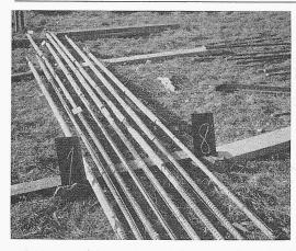
Bild 12. Versuche der schwedischen Eisenbahnverwaltung zeigen den schlechten Füllungsgrad injizierter
