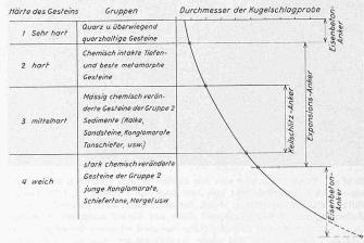
Bild 11. Eignung der Gesteine zur Verankerung und Bereich der Ankertypen
