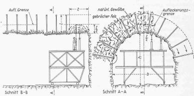
Bild 2. Schematische Darstellung der Ankerungswirkung
