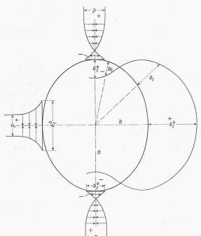
Bild 1. Schematische Darstellung der Verteilung der Tangentialspannungen am Rande und in der Umgebung eines elliptischen Tunnels; m=5
