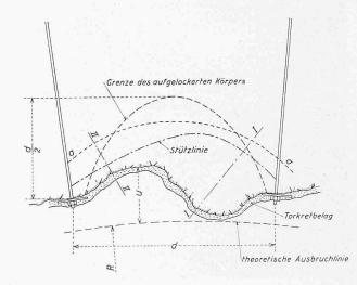
Bild 5. Schematische Darstellung der Belastung und der Kraftwirkungen auf eine torkretierte Oberfläche zwischen zwei Ankerpunkten
