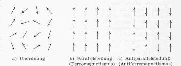
Bild 1. Unordnung und Ordnung bei den atomaren Magneten
