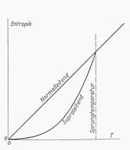
Bild 4. Grundsätzlicher Verlauf der Entropie von Metallelektronen in normalem und supraleitendem Zustand in Abhängigkeit der Temperatur
