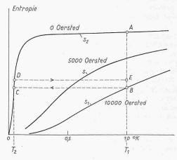
Bild 2. Entropie von Eisen-Ammonium-Alaun bei verschiedenen äussern Magnetfeldern. BCDE stellt einen reversiblen Kreislauf dar, wie er zur Temperatur-ermittlung gebraucht wird.
