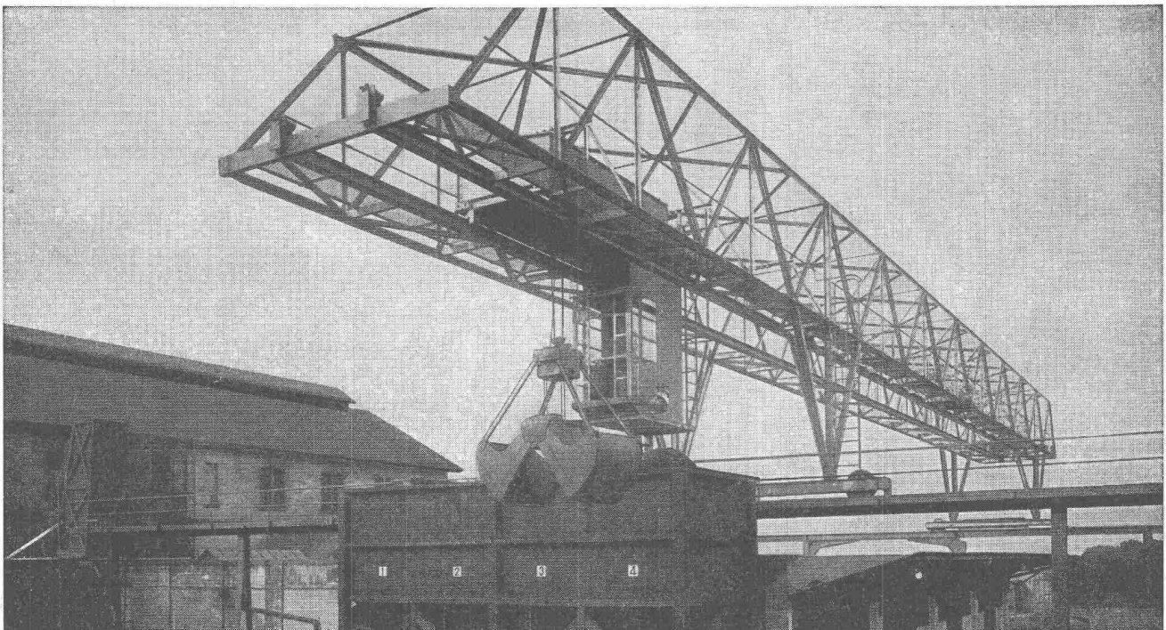
Verladebrücke in Schweisskonstruktion 2,5 t Tragkraft, 46 m Länge
