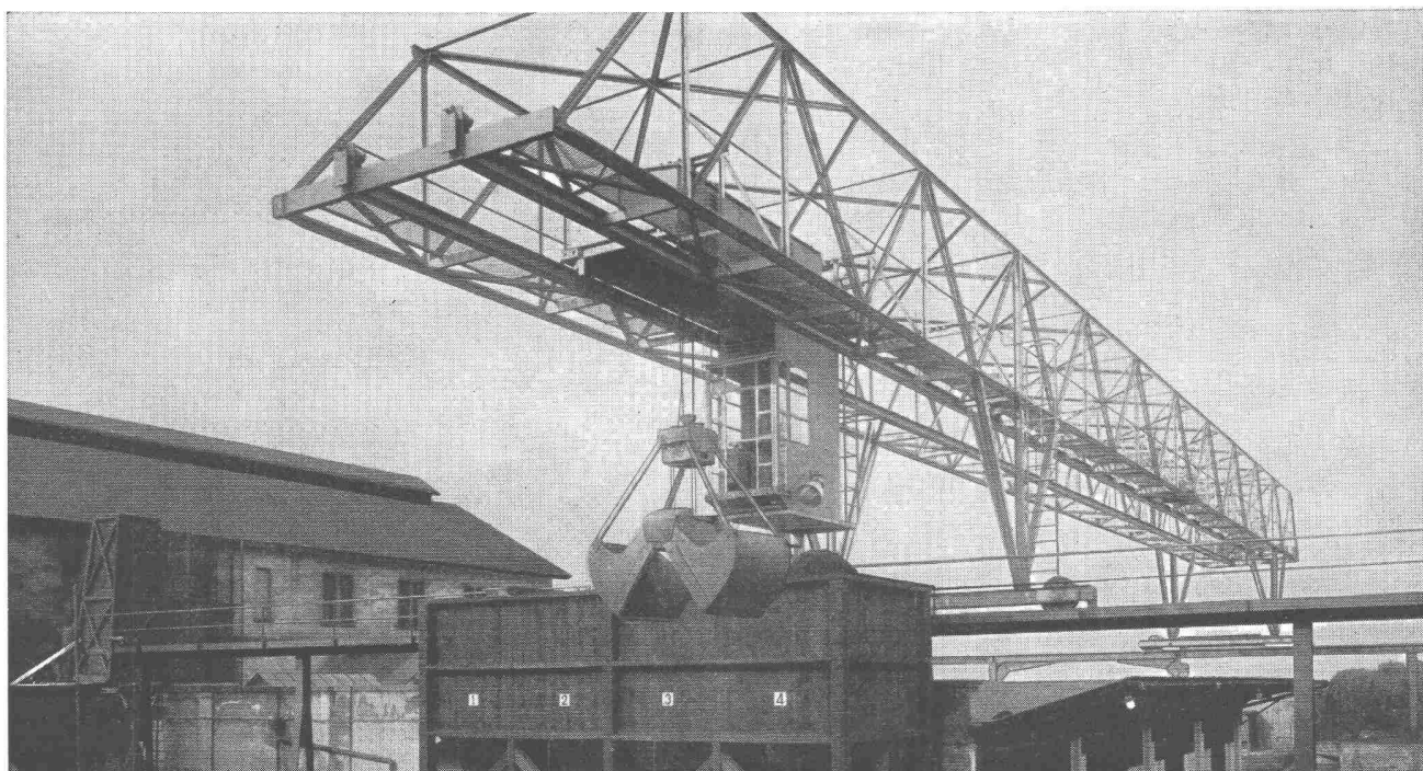
Verladebrücke in Schweisskonstruktion 2,5 t Tragkraft, 46 m Länge
