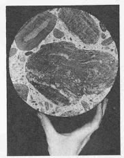
Bild 96. Maschinell hergestelltes Bollenstein-Mauerwerk
