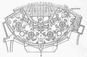
Bild 92. Kraftwerk Aigle, Horizontalschnitt 1:800 durch den Turbinenraum
