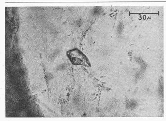
Bild 4. Dünnschliff eines Elba-Granits mit einem Zirkoneinschluss im Polarisationsmikroskop
