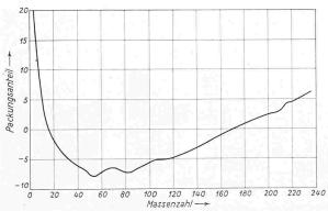
Bild 1. Packungsanteil als Funktion der Massenzahl (Bei den leichten Elementen wurden nur die geradzahligen Massenzahlen berücksichtigt)
