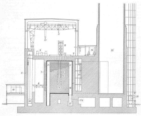
Bild 2. Querschnitt die Anlage Masstab Windscale. etwa 1:50
