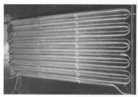
Bild 11. Heizelement mit elliptischen Rippen auf der gasberührten Seite
