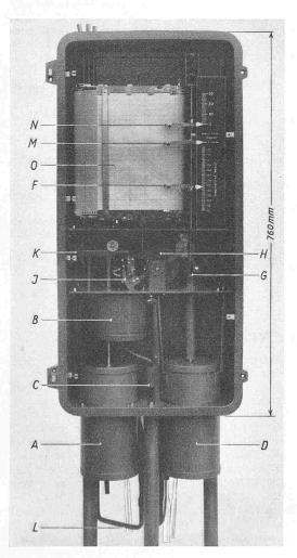
Bild 2 (links). Registrierapparatur des Niederschlags-Intensitätschreibers mit eingebautem Regenmesser
