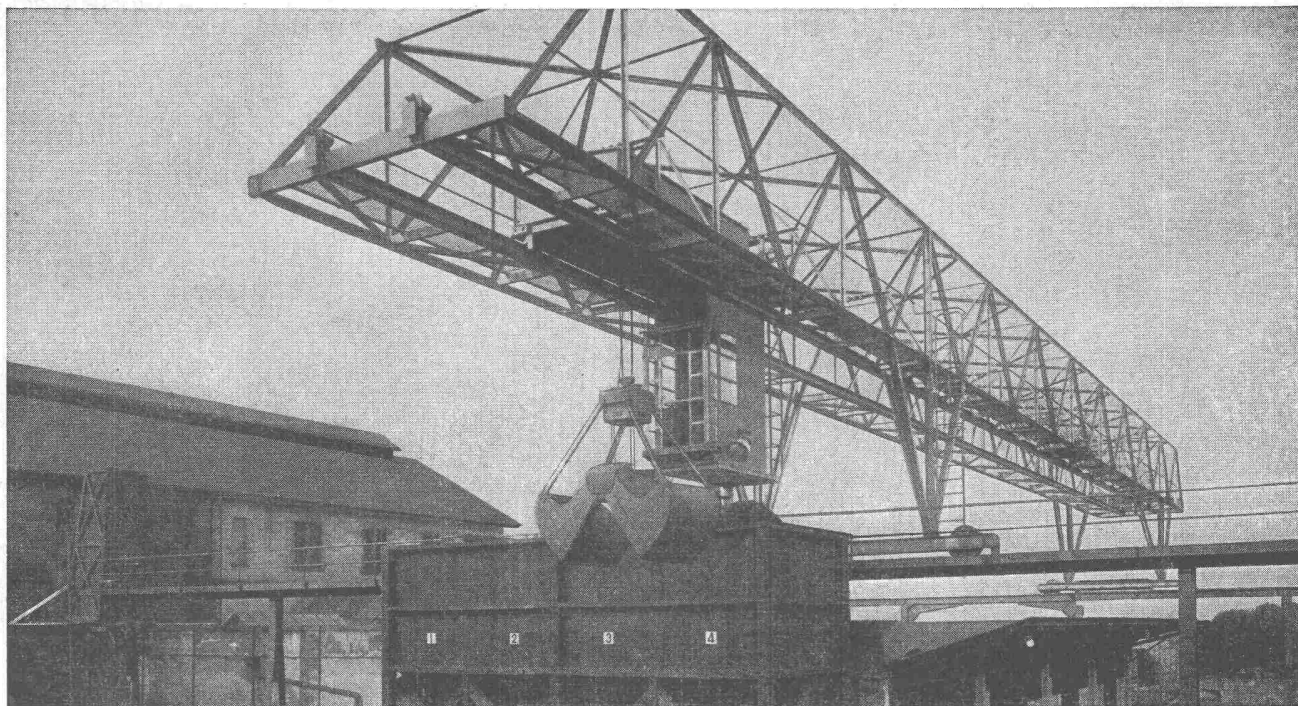
Verladebrücke in Schweisskonstruktion 2,5 t Tragkraft, 46 m Länge
