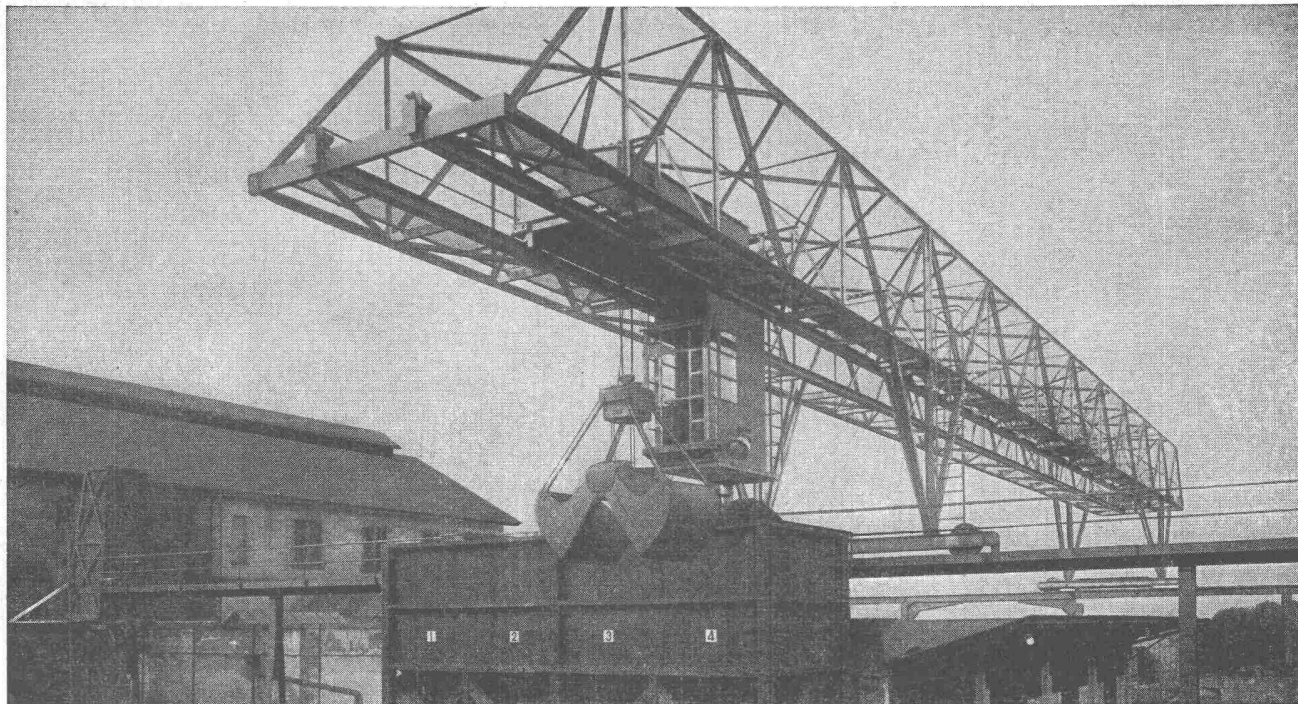
Verladebrücke in Schweisskonstruktion 2,5 t Tragkraft, 46 m Länge
