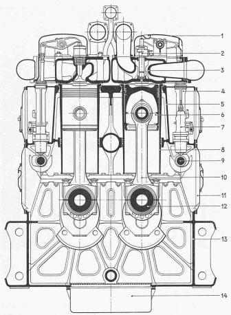
Bild 2. Schnitt durch den Sulzer-Viertakt-Lokomotivmotor 12 LDA 23
