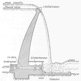
Bild 74. Staumauer Couesque, Schnitt 1:1000 in der Axe
