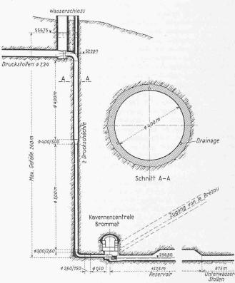
Bild 70. Kraftwerk Brommat; Druckstollen, Wasserschloss, Druckschächte, Zentrale und Unterwasserkanal; Längsschnitt 1:3000, Querschnitt 1:150
