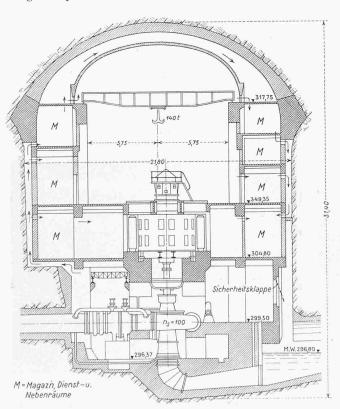
Bild 71. Querschnitt 1:300 durch die Kavernenzentrale Brommat
