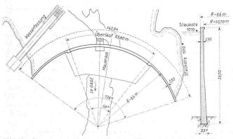
Bild 58. Staumauer du Gage, Plan 1:2000 und Schnitt 1:1000. Versuchs- und Experimentiermauer
