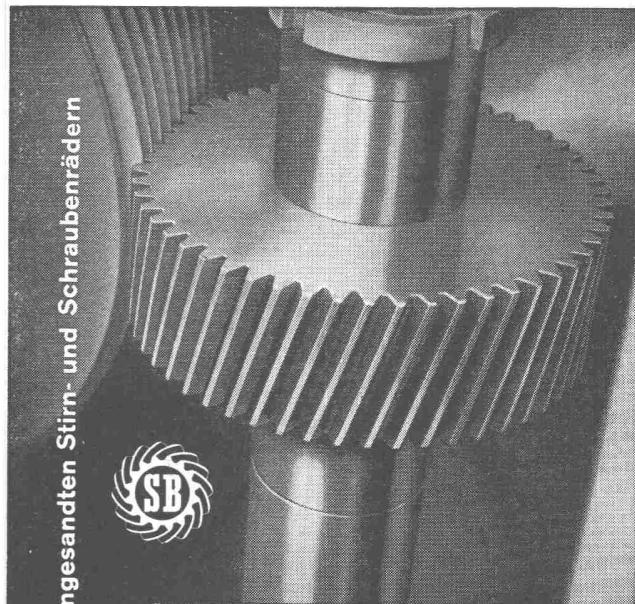
Zähneschleifen an eingesandten Stirn- und Schraubenrädern
