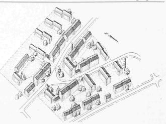
Bild 7. Beispiel einer Siedlung mit verschiedenen Geschosshöhen und gleicher Ausnützungsziffer wie in Bild 6
