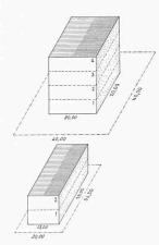
Bild 5. Bei gleichbleibender Ausnützungsziffer und abnehmender Grundstückgrösse wird die Variationsmöglichkeit der Geschosszahl immer kleiner, weil die Gebäudefläche sowie die Grenz- und Gebäudeabstände nicht beliebig verkleinert werden können. Aus diesem Grund ist ein Variieren der Geschosszahlen auf grund einer gegebenen Ausnützungsziffer nur bei grösseren Grundstücken sinnvoll
