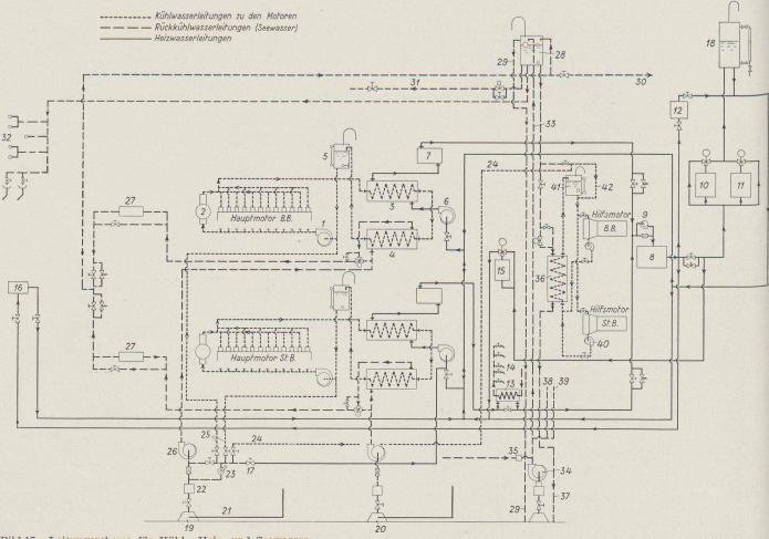
Bild 17. Leitungsschema für Kühl-, Heiz- und Seewasser
