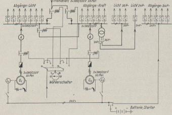
Bild 16. Schaltschema des elektrischen Bordnetzes
