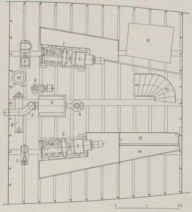
Bild 15. Elektrische Zentrale mit Hilfsmaschinen, 1:60
