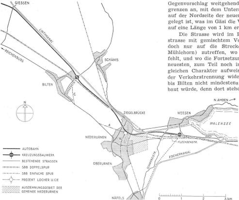
Bild 1. Führung der Walenseestrasse in der Linthebene nach dem Vorschlag des Verfassers, M. 1:80 000
