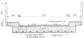
Bild 21. Brücke über den Oberwasserkanal 1:500 und 1:65
