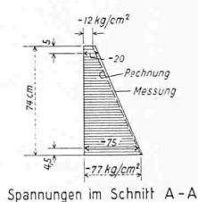
Bild 8. Deformationen und Spannungen für die zweite Vorspannetappe (60%)
