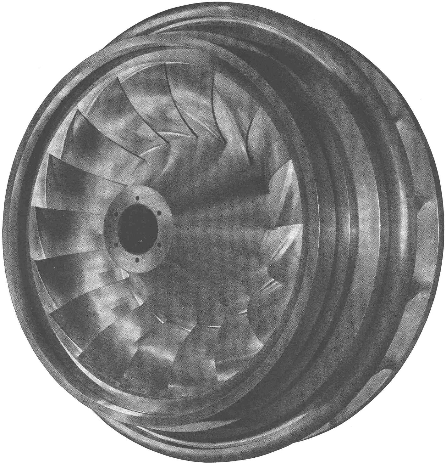
Laufrad für HD-Francisturbine der Zentrale Fionnay (Schweiz). Leistung **63 000 PS**, Drehzahl 750 U/min., Gefälle max. **455 m**.
