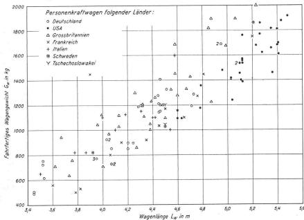
Bild 4. Fahrfertiges Wagengewicht  $G_w$  von Personenkraftwagen gemäss der Aufstellung im «Bosch Kraftfahrtechnisches Taschenbuch 1954»
