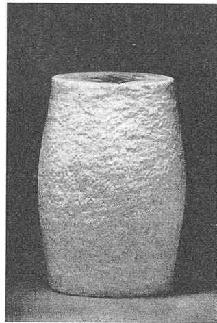
Bild 4. Marmor. Druckversuch p_a = 1000 Atü. Zylinder \phi 20 mm, Länge 45 mm
