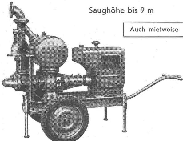
Leistungen 1—5000 l/sek. Kein Bodenventil. Keine Klappe im Saugstutzen. Keine Hilfs-Vakuum-Pumpe. Jederzeitiges automatisches Ansaugen auch nach Lufteintritt im Saugrohr. Keine reibenden, sich abnutzenden Dichtungsfächen, daher störungsfrei auch bei **Schlamm-, Sand- und Kiesförderung**.
