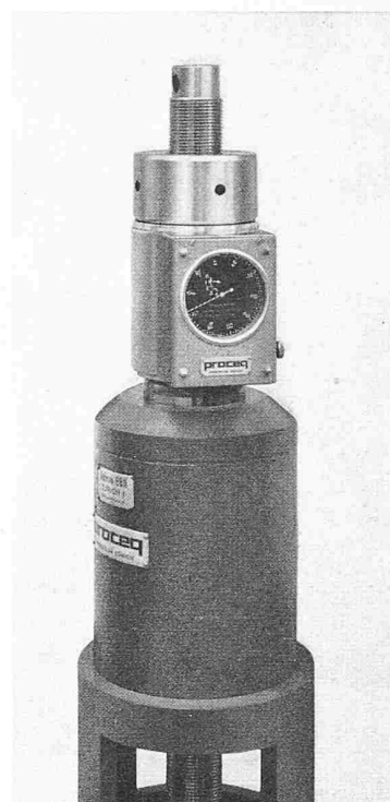
Bild 9 (oben). Druck-Dynamometer mit Traggehäuse für 20 bis 150 Tonnen Druckkraft mit Zentrumsloch
