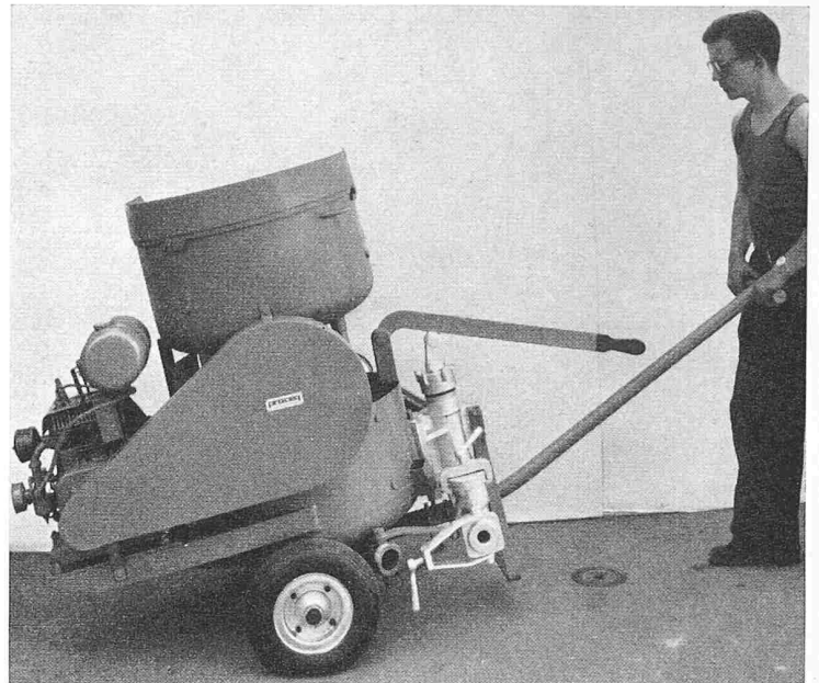
Bild 21. Doppelmischer mit Motorantrieb und Hand-Injektionspumpe
