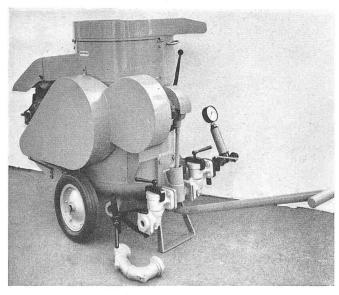
Bild 22. Doppelmischer und Pumpe BBRV mit Motorantrieb
