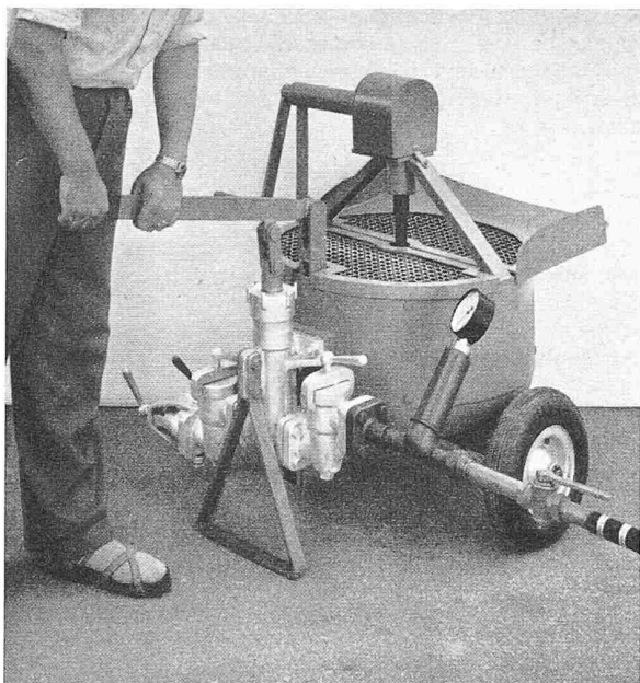
Bild 20. Misch- und Injektionsgerät BBRV für Handbetrieb
