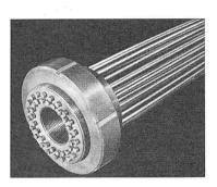
Bild 15 (links). BBRV Anker B125, bestehend aus 42 Drähten  $\phi$  6 mm, für 125 Tonnen Vorspannkraft
