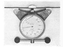
Bild 7 (rechts). Drahtspannungsmesser für Drähte  $\phi$  4 bis 7 mm
