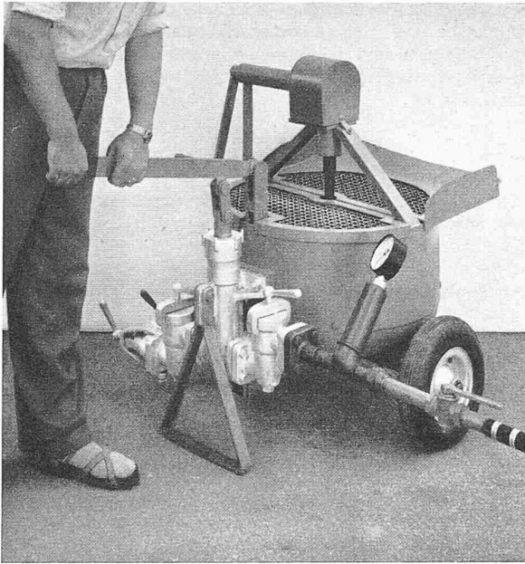
Bild 20. Misch- und Injektionsgerät BBRV für Handbetrieb
