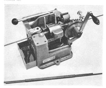
Die in Bild 6 dargestellte Drahtbindemaschine (1) erfüllt die vier oben aufgeführten Bedingungen und hat deshalb Eingang in eine grosse Zahl von Spannbetonbetrieben auf der ganzen Welt gefunden. Das Prinzip der damit erzeugten Drahtverbindung ist einfach: Die nebeneinander liegenden Enden zweier zu stossender glatter oder profilierter Drähte von 2 bis 6 mm Durchmesser werden mit hochwertigem Stahldraht von kleinem Durchmesser auf eine bestimmte Länge L unter Spannung umwickelt, wobei das in
