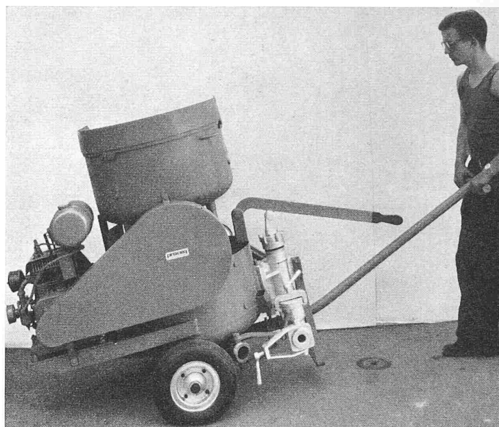
Bild 21. Doppelmischer mit Motorantrieb und Hand-Injektionspumpe
