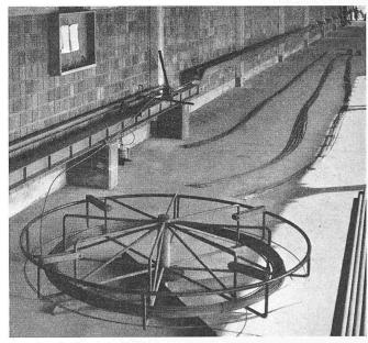
Bild 2. Drahthaspel und Ablängeeinrichtung nach Verfahren BBRV
