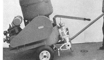
Bild 20. Misch- und Injektionsgerät BBRV für Handbetrieb
