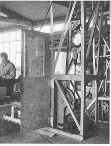
Bild 29. Vorspanneinrichtung für 2  $\phi$  3 bis 5 mm
