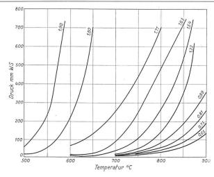
Bild 4. Dissoziationsdruck von Zikoniumhydriden Zr H. Die Zahlen geben den Hydrierungsgrad an; die Zahl 1,80 z. B. bedeutet, dass im Mittel 1,8 Wasserstoffatome pro 1 Atom Zr hydriert sind
