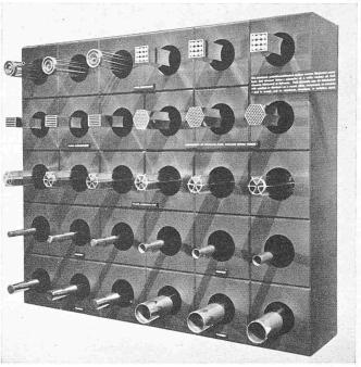
Bild 12. Typische Formen von Brennstoffelementen
