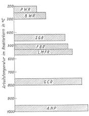
Bild 1. Vergleich der relativen Anlagewirkungsgrade verschiedener Reaktoren bei ihren Betriebstemperaturen
