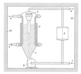
Bild 9. Schema eines Gaskreislauf-Reaktors, bei dem Brennstoff und Moderator im Gas suspendiert sind
