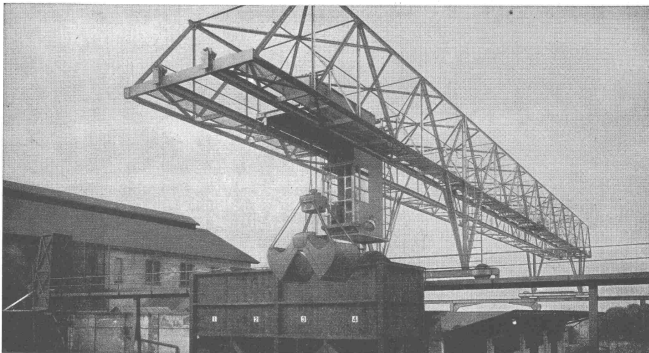
Verladebrücke in Schweisskonstruktion 2,5 t Tragkraft, 46 m Länge
