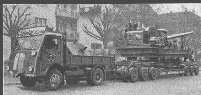
Transport eines 54 Tonnen schweren Rammenfusses auf dem 24fach bereiften Schwertransportanhänger mit dem starken Allrad-Zugwagen mit Seilwinde.
