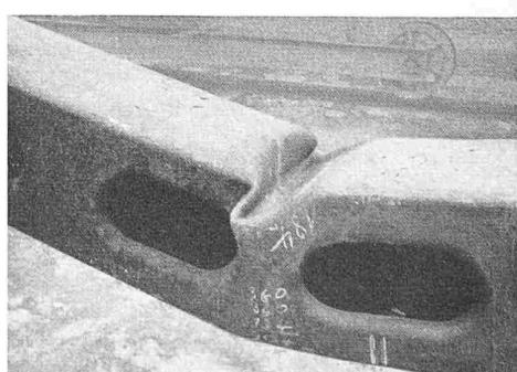
Fig. 7. Zone de voilement, côté trous
