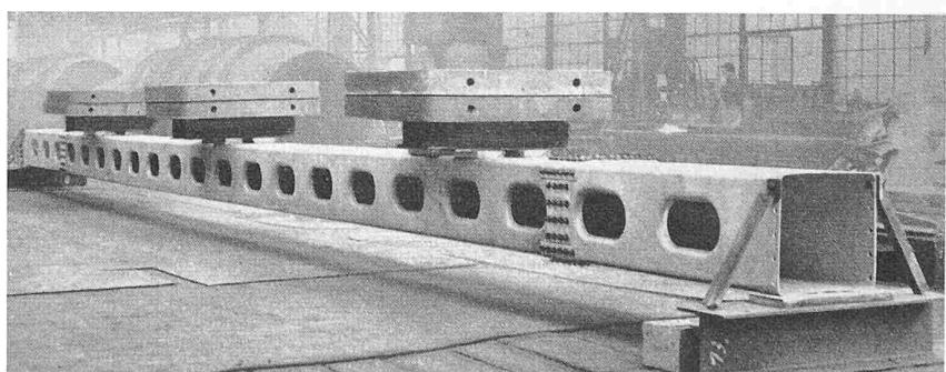
Fig. 10. Essai d'un joug recuit et zingué
