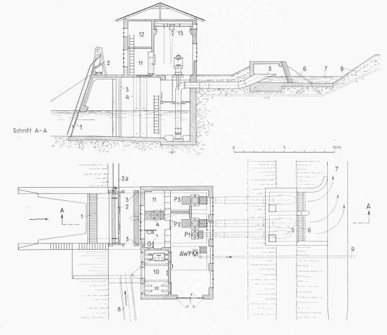
Bild 8. Grundriss und Querschnitt der Pumpanlage Holderbank
