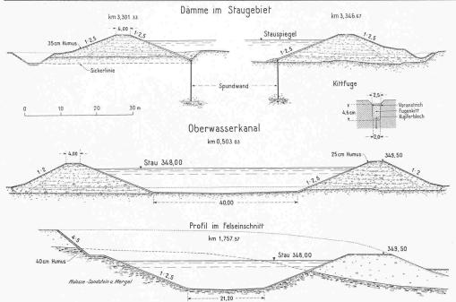
Bild 6. Querschnitte der Staudämme und des Oberwasserkanales
