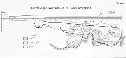
Bild 7. Längenprofil des linksufrigen Staudammes mit Spundwanddichtung im Dammunter-grund
