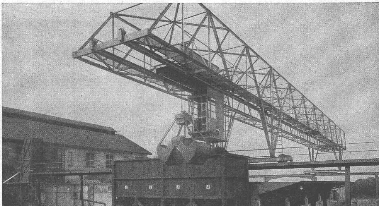
Verladebrücke in Schweisskonstruktion 2,5 t Tragkraft, 46 m Länge
