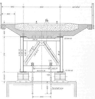
Bild 4. Querschnitt beim obern Endlager mit Abhebesicherung, 1:50
