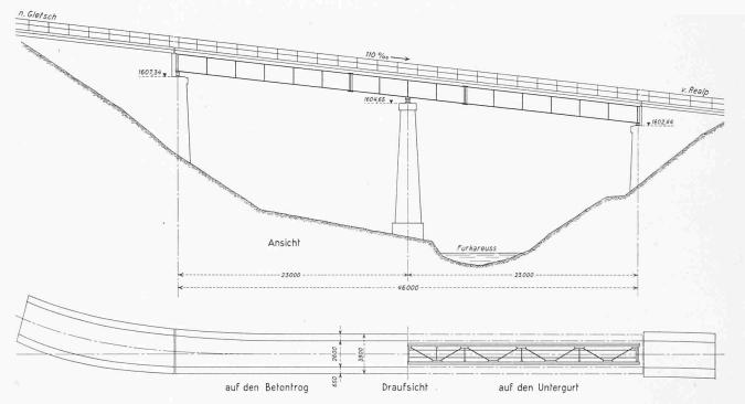
Bild 2. Wilerbrücke der Furka-Oberalp-Bahn, Grund- und Aufriss, Masstab 1:400
