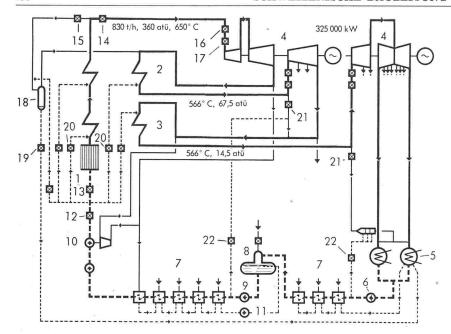
von diesem durch den Zwischenüberhitzer 2 in die dritte Stufe der Hochdruckgruppe, deren Abdampf durch den Zwischenüberhitzer 3 mit 14,5 at und 566° C in den Niederdruckteil der Turbine gelangt. Zu beachten ist, dass alle Turbinenstufen an den Dampfeintrittstellen mit Schnellschlussventilen versehen werden, die zusammengekuppelt sind.
