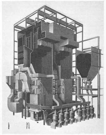
Bild 43. Gesamtaufbau des Kessels für die Zentrale Eddystone
