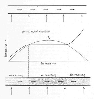
Bild 37. Verdampfungsvorgang bei unterkritischem Druck (unten) und überkritischem Druck (oben)
