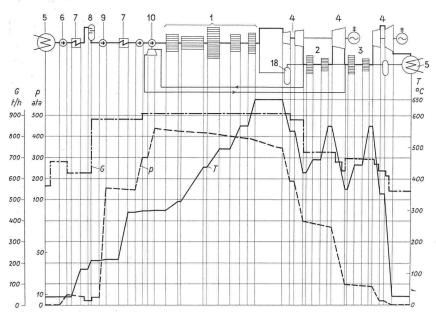
Veränderung von Menge, Druck und Temperatur des Dampfes beim Durchströmen der einzelnen Anlageteile in der Dampfkraftzentrale Eddystone, G Dampfmenge: P Dampfdruck; T Dampftemperatur, Uebrige Bezeichnungen s. Legende zu Bild 38
