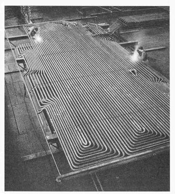
Bild 42. Teil einer Seitenwand-Auskleidung einer Brennkammer
