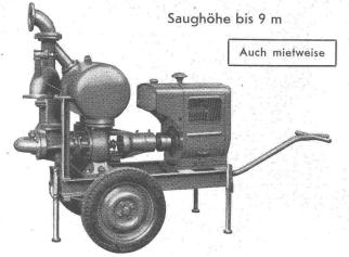
Leistungen 1—5000 I/sek. Kein Bodenventil. Keine Klappe im Saugstutzen. Keine Hilfs-Vakuum-Pumpe. Jederzeitiges automatisches Ansaugen auch nach Lufteintritt im Saugrohr. Keine reibenden, sich abnützenden Dichtungsflächen, daher störungsfrei auch bei Schlamm-, Sand- und Kiestörderung.
