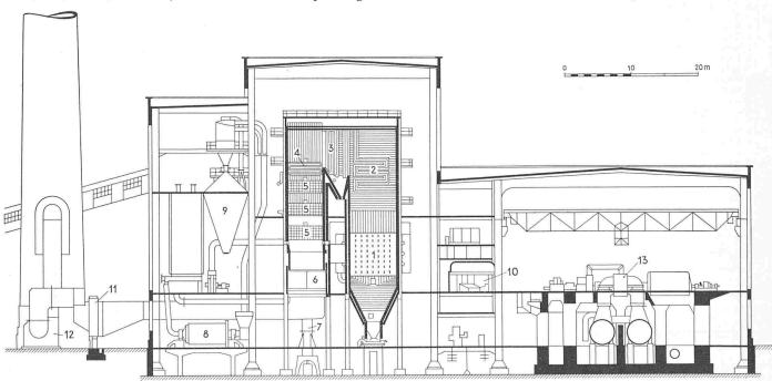
Bild 34. Schnitt durch eine Dampfkraftzentrale mit zwei Einheiten von je 60 000 kW in Blockschaltung, Masstab 1:600
