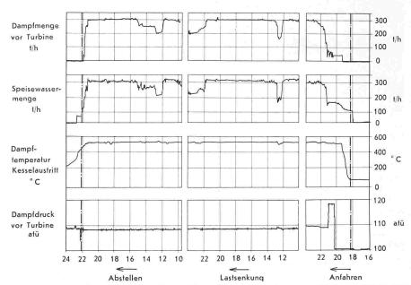
Bild 31. Betriebsdiagramme einer Einrohr-Dampferzeugungsanlage von 300 t/h bei 5300 C und 127 atü
