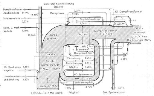
Bild 19. Wärmefluss-Schema der Vorschaltanlage nach dem Schema Bild 17
