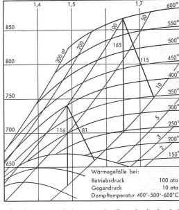
Bild 18. Zustandsänderungen des Dampfes in den beiden Vorschaltanlagen nach dem Schema Bild 17 im is-Diagramm bei Expansion von 100 ata und 400 bzw. 6000 C auf einen Gegendruck von 10 ata
