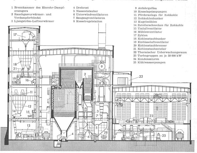
Bild 25. Schnitt durch das Hochdruck-Dampfwerk Monceau-sur-Sambre, Masstab 1:500
