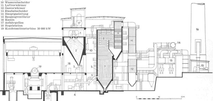
Schnitt durch eine Dampfkraftzentrale in Spanien mit vier Dampferzeuger-Einheiten von je 125 t/h in halboffener Bauweise, 1:500 Bild 32.
