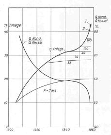
Bild 2. Zunahme des Anlagewirkungsgrades und Abnahme des Verhältnisses der Kondensationswärme zur Brennstoffwärme im Laufe der Zeit. Die dünnen Linien zeigen die Gesamtwirkungsgrade für bestimmte Kesseldrücke
