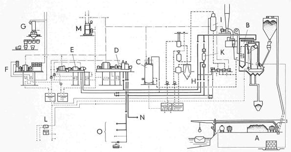
Bild 6. Schaltbild der zentralen Energieversorgungsbetriebe einer chemischen Fabrik
