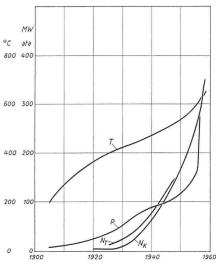
Bild 1. Steigerung des Dampfdruckes und der Einheitsleistungen im Laufe der Zeit. TFrischdampfdruck,  $N_T$  Einheitsleistung des Turbinensatzes,  $N_K$  Einheitsleistung des Dampferzeugers. Die Kurven stellen die Entwicklung der mittleren Werte dar.
