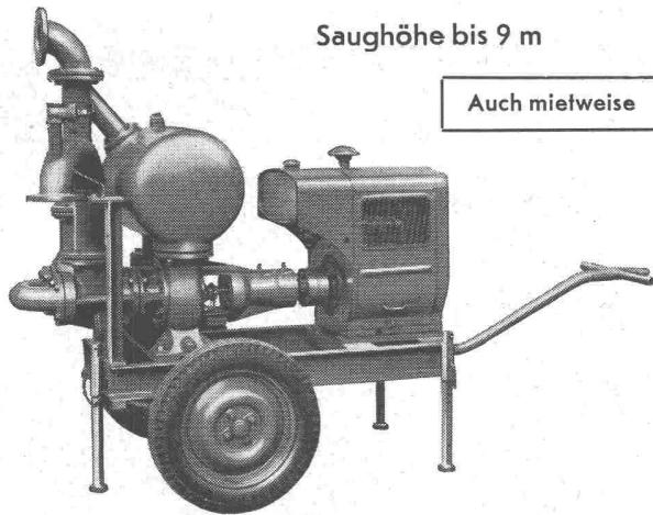
Leistungen 1—500 l/sec. Kein Bodenventil. Keine Klappe im Saugstutzen. Keine Hilfs-Vakuum-Pumpe. Jederzeitiges automatisches Ansaugen auch nach Lufteintritt im Saugrohr. Keine reibenden, sich abnutzenden Dichtungsfächen, daher störungsfrei auch bei Schlamm-, Sand- und Kiesförderung.
