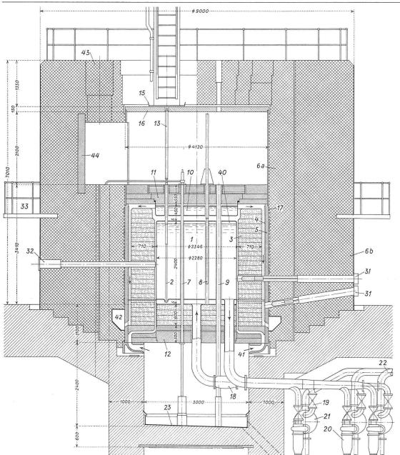
Bild 1. Schnitt durch den schweizerischen Versuchsreaktor, 1:75
