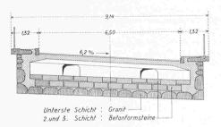
Bild 5 (links). Schnitt a—a im Scheitel: 1:150
