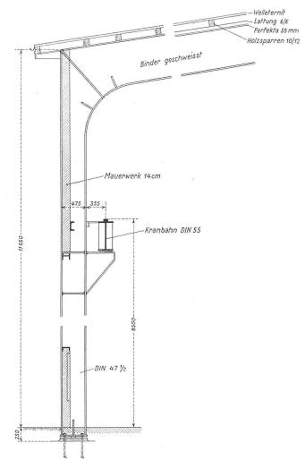
Bild 3. Detail 1:60 der Rahmenkonstruktion
