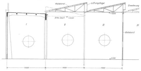
Bild 2. Querschnitt 1:300 durch die umgebaute und erweiterte Anlage
