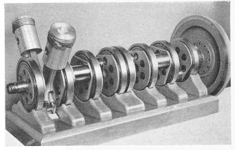
Bild 10. Kurbelwelle mit Rollenlagern und einem Kolbenpaar
