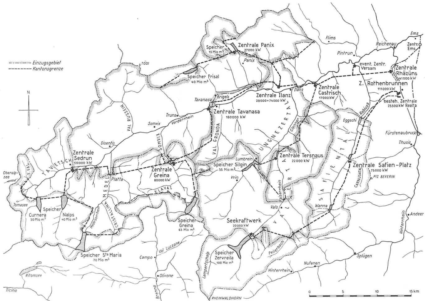
Bild 1. Ausbau der Wasserkräfte des Bündner Oberlandes und des Hinterrheins von Fürstenaubruck bis Ems. Lageskizze 1:333 000
